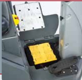
Integrert innbygd lader gjør det enkelt å lade batteriet ved et hvert strømuttak.
